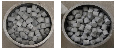
شکل ۲- آرایش دانه‌های بتنی ترک دار و بدون ترک در داخل قالب استوانه‌ای، بدون ترک (راست)، ترک‌دار (چپ)
