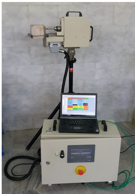
شکل ۳- نمایشی از دستگاه حفاری با قابلیت حفاری و اندازه‌گیری داده‌های حفاری
