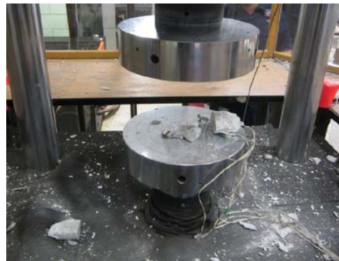
شکل ۳: انفجار هولولوکوگرانود یورت‌ها به هنگام شکست و پخش شدن اجزای آن
