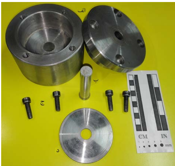
شکل ۳: قسمت‌های مختلف دستگاه پانچ استوانه‌ای: نمای بدنه و درپوش از بالا (الف)، سنبه پانچ کننده (ب)، پیچ‌های محکم کننده دو بخش دستگاه (ج) و پولک فولادی سوراخ‌دار (د)
