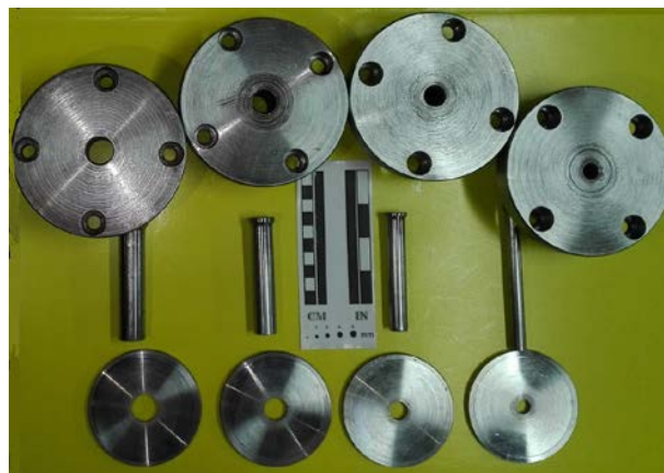
شکل ۴: درپوش‌ها، سنبه‌ها با قطرهای ۱۰، ۱۳، ۱۶ و ۱۹ میلی‌متر (از راست به چپ) و پولک‌های فولادی
