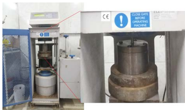
شکل ۵: نحوه قرارگیری دستگاه پانچ استوانه‌ای در دستگاه
