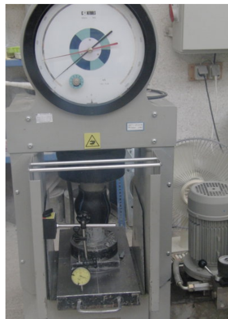
شکل ۱۳: نمونه ستون دارای HDC تحت بارگذاری
