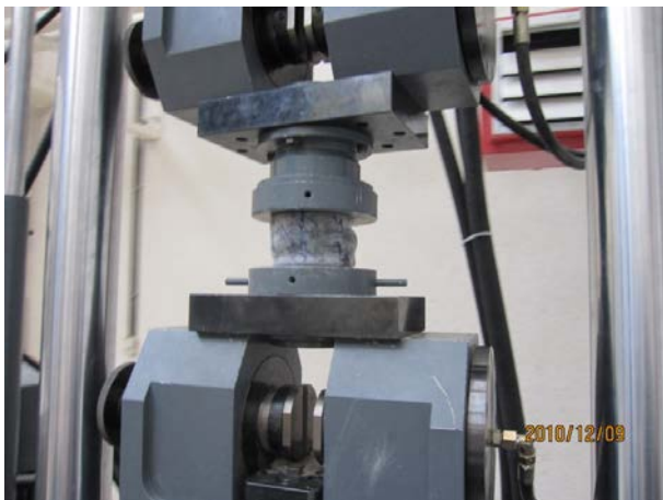
شکل ۱۲: نمونه HDC تحت بارگذاری در UTM
