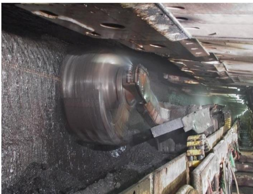
شکل ۲- ماشین درام شیر در حال کار در یک پهنه جبهه کار طولانی
