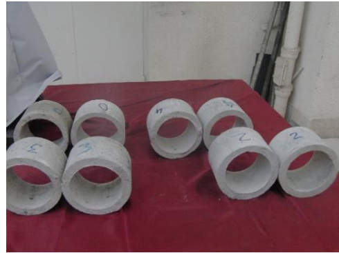
شکل ۶- نمونه مقاطع بتنی تونل در مقیاس آزمایشگاهی
