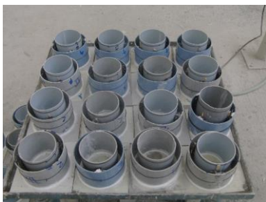
شکل ۵- نمونه قالب‌های تهیه شده جهت ساخت مقاطع بتنی تونل‌ها
