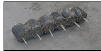
شکل ۷- نمایی از المان بتنی با شکل پذیر بالا ساخته شده در مقیاس آزمایشگاهی جهت استفاده در مقاطع تونل‌ها
