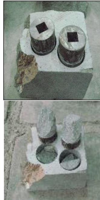
شکل ۵: شکست مغزه ها در آزمون پیچش
