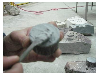
شکل ۲. چسباندن استوانه فولادی روی سنگ ها
