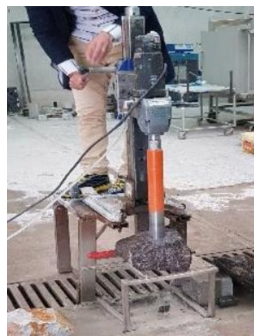
شکل ۱. کرگیری از سنگ ها
