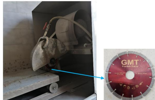
شکل ۲- نمایی از دستگاه برش و دیسک مورد استفاده در تحقیق
