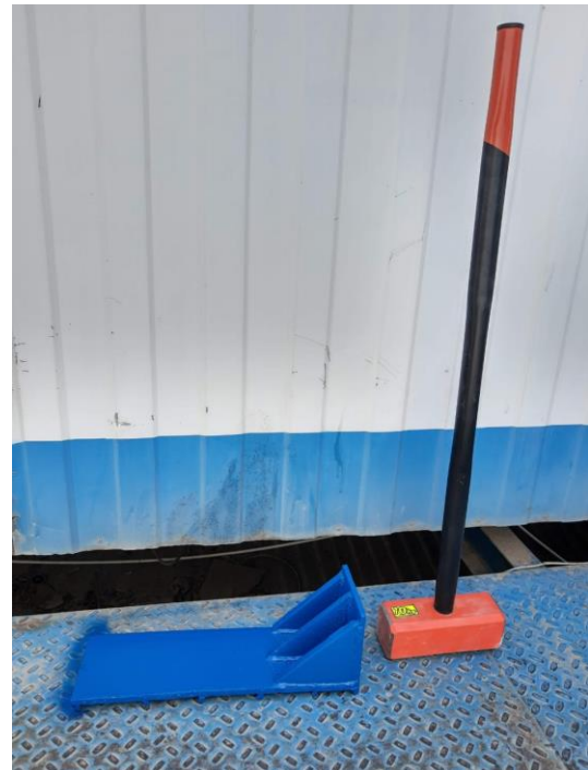
شکل ۱۷- پتک ۱۰ کیلویی و پد آهنی جهت تولید و انتقال موج برشی به زمین
