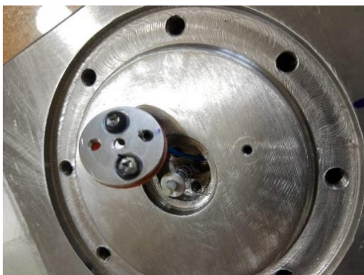
شکل ۱۳- سنسور جابجایی پیش از نصب روی تیغه
