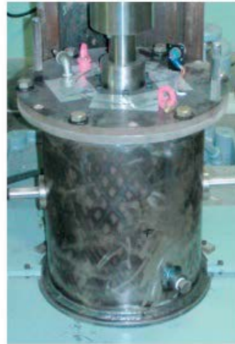
شکل ۸- تصویر و طرح شماتیک دستگاه ساینده‌گی خاک PENN STATE [۲۶]
