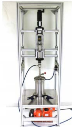
شکل ۱۰- تصویر و طرح شماتیک دستگاه ساینده‌گی خاک زمین نرم (SGAT) [۸]
