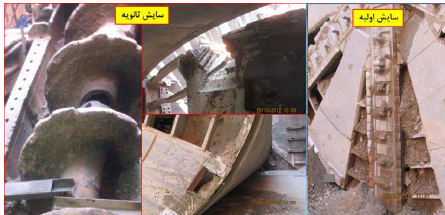
شکل ۲- سایش‌های اولیه و ثانویه دستگاه TBM
