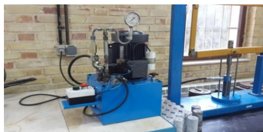
شکل ۲: تصویری از دستگاه طراحی شده برای تزریق سیال در داخل سنگ
