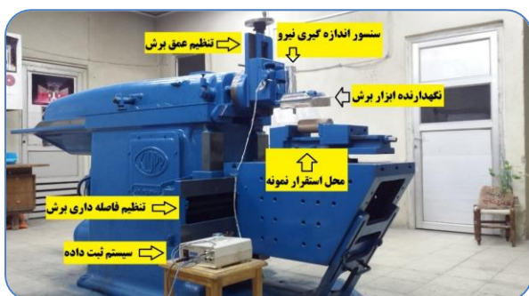
شکل ۲- ماشین کوچک‌مقیاس برش خطی سنگ آزمایشگاه حفاری مکانیزه دانشگاه تربیت مدرس
